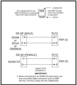
FIGURE 4. PAP-32 RJ12 Cable Diagram
